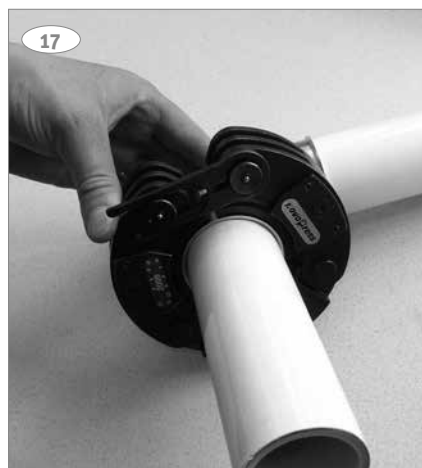
14: Placera pressringen på PressCheck®-kopplingen.
