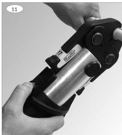
11 + 12: Starta pressmaskinen och ta bort maskinen när det är färdigpressat.
